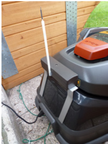
▲ An der Ladestation zu erkennen: der nachträglich angebaute Funkfensterkontakt mit nach oben geführter Antenne
