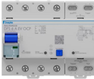
Der DFS 6 A EV OCP HD, von uns auch liebevoll „Super-EV“ genannt, kombiniert Fehlerstrom- und Überstromschutz kompakt in einem nur sechs Teilungseinheiten schmalen Gerät. Er bietet den gewohnten zuverlässigen Schutz der EV-Ausführungen von Doepke: die aktive Zusatzfunktion erfasst glatte Gleichfehlerströme  $\geq 6$  mA, die beim Laden von E-Fahrzeugen auftreten können.
